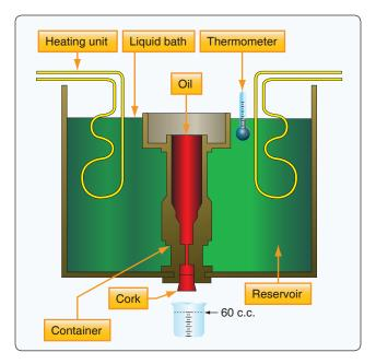
Figure 12-1. Saybolt viscosimeter.
